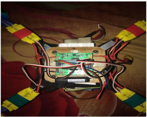
FIG ESC CONNECT WITH FLIGHT CONTROLLER
