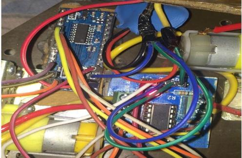
FIG. ARDUINO NANO TO MOTOR DRIVER
