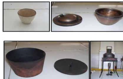
(a) Porcelain crucible (b) Inner iron crucible (c) Outer iron crucible (d) Experimental setup
