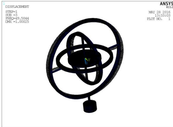
c. 3 rd Mode ( f_{n3}=49.5\text{Hz} )
