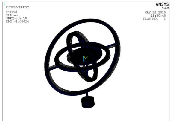
h. 8 th Mode ( f_{n8}=250.50\text{Hz} )
