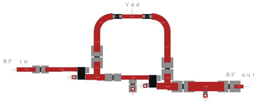
Figure 2. Layout Of LNA Case 1
