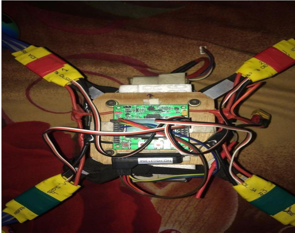
FIG ESC CONNECT WITH FLIGHT CONTROLLER
