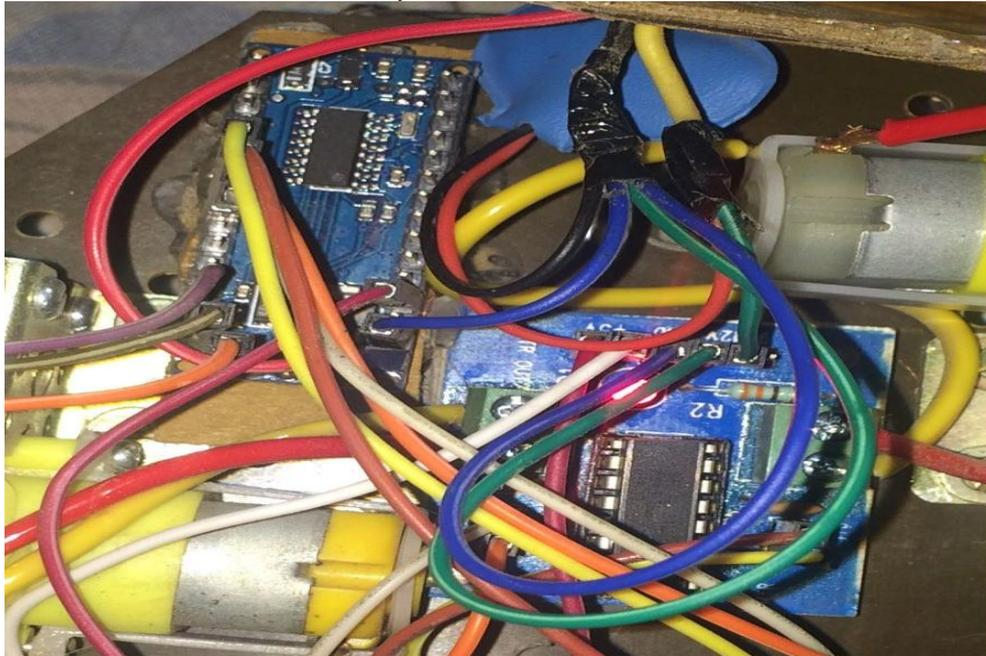
FIG. ARDUINO NANO TO MOTOR DRIVER
