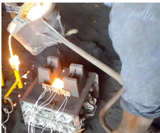
Fig 3.2 Pouring of Metal
